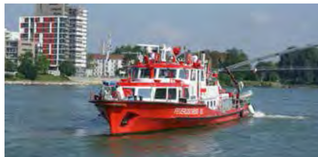
Feuerlöschboote sind nicht nur für die Brandbekämpfung vom Wasser aus prädestiniert, sondern können auch über einen Explosionsschutz verfügen.
