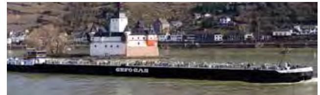
Tankmotorschiff Typ G mit Zylindertanks zum Transport von Gasen
